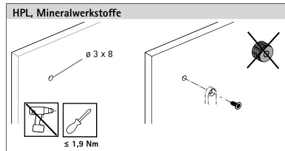
Die Befestigung ist material- und qualitätsabhängig zu wählen und mittels geeignetem Test abzusichern.
