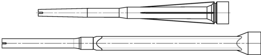
**Injektionshilfe und Verlängerungsschlauch für Statikmischer**
