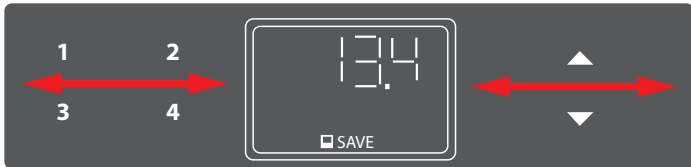
Abb. 50: Aktivierung und Deaktivierung der Sperre beim LegaDrive Touch Comfort Handschalter erfolgt durch Wischen nach links oder rechts
