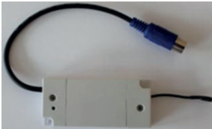
Abb. 13: Empfangsmodul für Funkschalter
