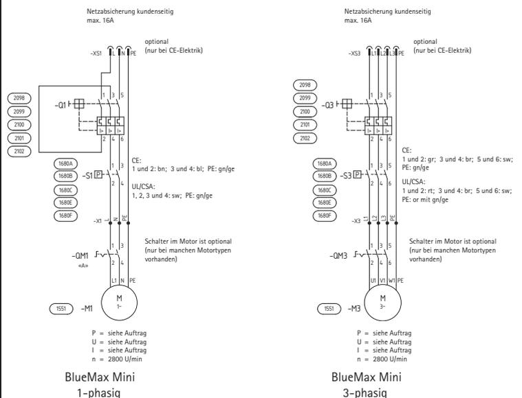
Verwenden Sie einen entsprechenden Stecker nach DIN VDE oder IEC-Norm. Im Netz ist eine Vorsicherung vorzusehen.
