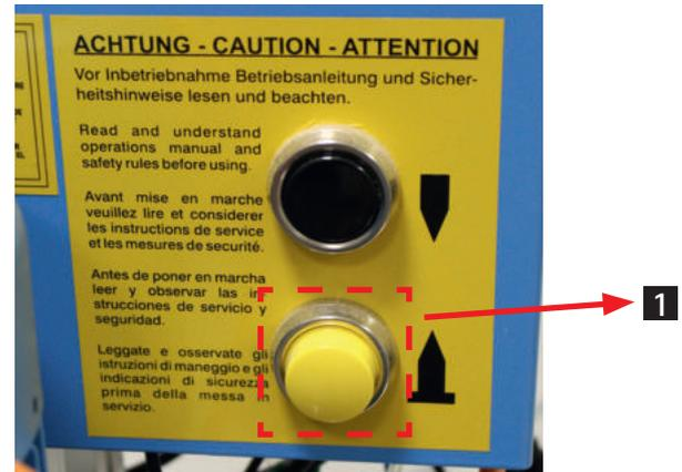
Abb. 27: gelbe Taste: Lösen der Niederhalter
