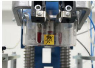
Abb. 29: Bohrspindeln mit Kappe
