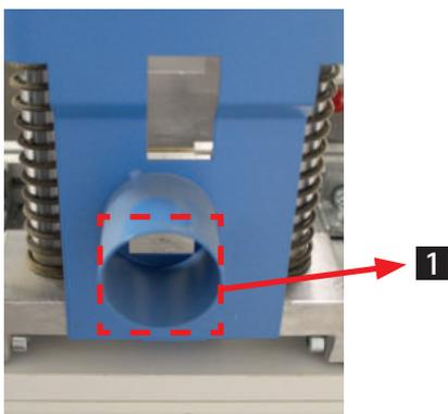
Abb. 18: Absaugstutzen
