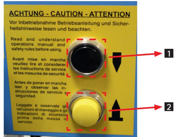
Abb. 37: Handventil und Tastschalter
