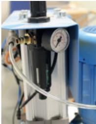
Abb. 4: Wartungseinheit Pneumatik
