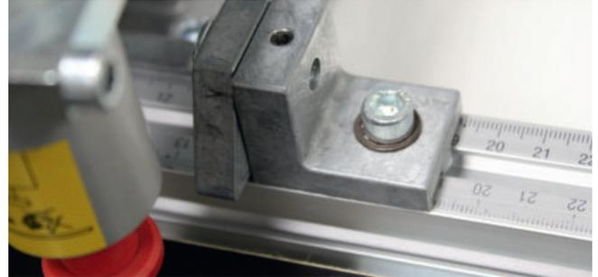
Abb. 32: Pendelanschlag mit Innensechskantschraube
