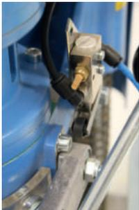
Abb. 20: Schwenkbügel mit Tastrolle
