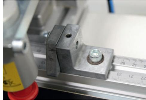
Abb. 24: Pendelanschlag
