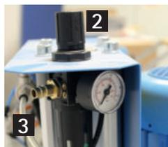
Abb. 7: Druckluftanschluss
