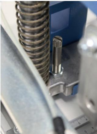
Abb. 30: Bohrtiefenanschlag mit Sechskantschraube
