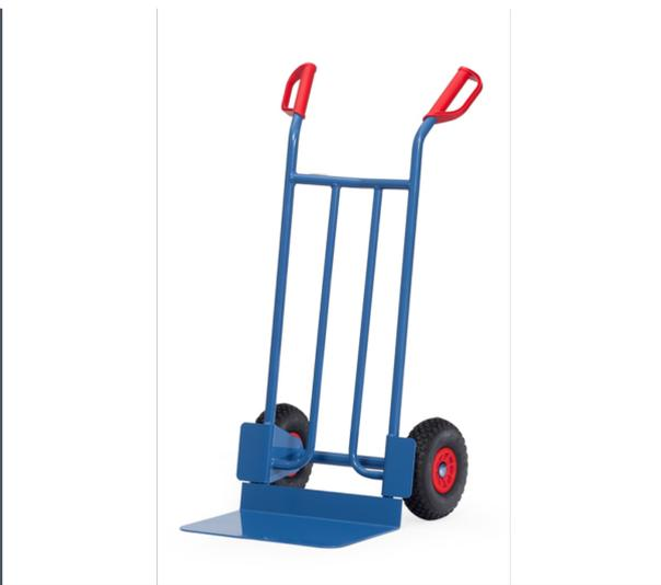
Stahlrohr-Sackkarre mit Stahlblechschaufel, stabile Schweißkonstruktion, pulverbeschichtet, blau, RAL 5007. fetra Sicherheitsgriffe. Stahlblechschaufel anschraubbar und dadurch austauschbar. Räder mit pannensicherer PU-Bereifung, auf Kunststoff-Felgen, Naben mit Rollenlagerung. Zerlegte Anlieferung.
