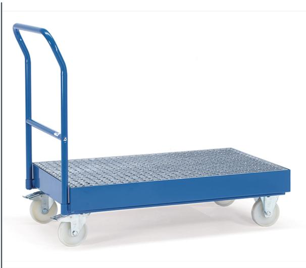
Stahl-Konstruktion geschweißt, Wanne 100 mm hoch, öldicht, pulverbeschichtet blau RAL 5007. Mit bündig eingelegtem Gitterrost, Maschenweite 31 x 31 mm, feuerverzinkt. 2 Lenk- und 2 Bockrollen, Naben mit Rollenlagerung. Feststeller an den Lenkrollen. Zum Transport von 1 oder 2 200-Liter-Fässer geeignet. Verhindert Schäden durch Tropföl. Auffangwanne 45 Liter.
