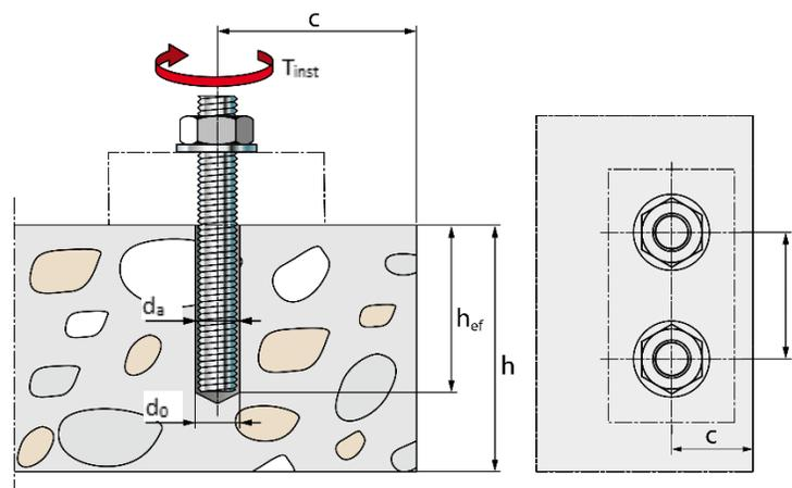
FIGURE 1—INSTALLATION PARAMETERS
