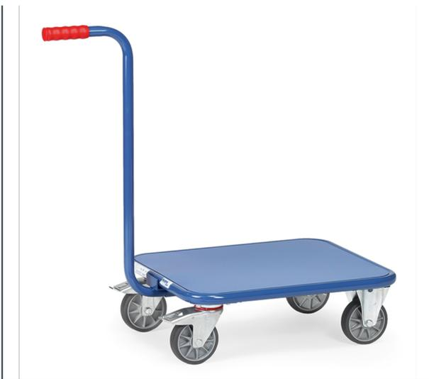
Stahlrohr geschweißt, mit Stahlblechplattform, Plattform mit bündig eingeschweißtem Stahlblech 2 mm stark. Pulverbeschichtet brillantblau RAL 5007. Griff anschraubbar. 2 Lenk- und 2 Bockrollen, TPE-Bereifung (spurlos), Naben mit Rillenkugellager, Feststeller an den Lenkrollen.
