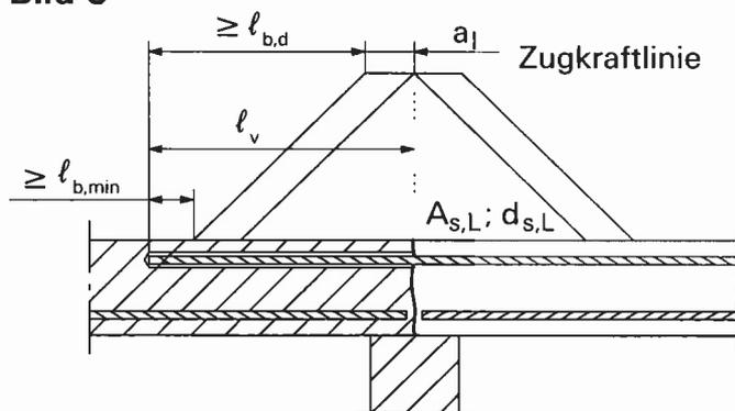
Verankerung von Bewehrung zur Deckung der Zugkraftlinie
