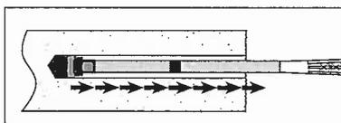
Verfüllen des Bohrloches vom Bohrlochgrund aus. Die Injektionshilfen werden auf die Injektionsverlängerung aufgesetzt. Der spürbare statische Gegendruck unterstützt ein blasenfreies Verfüllen.
