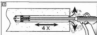
Bohrloch vom Grund her mit passendem Düsenaufsatz
