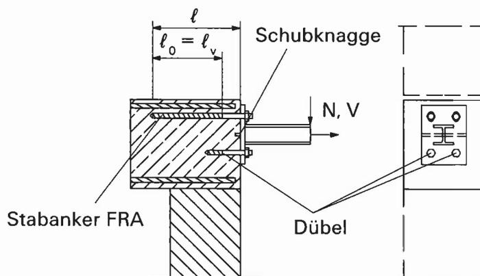
Übergreifungsstoß für die Verankerung von auskragenden Bauteilen
