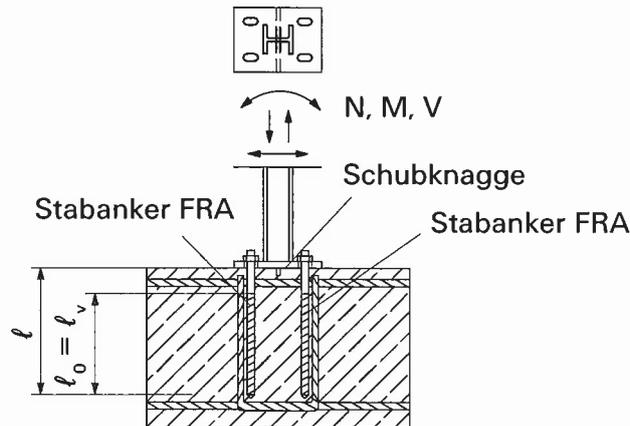
Übergreifungsstoß einer biegebeanspruchten Stütze an ein Fundament
