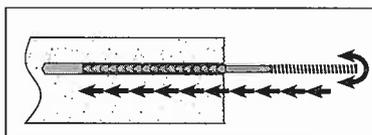
Unter kräftigem Druck und gleichzeitigem Drehen wird der Bewehrungsstab oder der Stabanker FRA bis zur Setztiefenmarkierung in das Bohrloch eingeführt.
