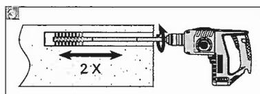
Passende Edelstahlbürste mit Verlängerung in elektrische Bohrmaschine spannen und das Bohrloch 2 mal ausbürsten.
