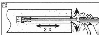
Bohrloch vom Grund her mit passendem Düsenaufsatz
