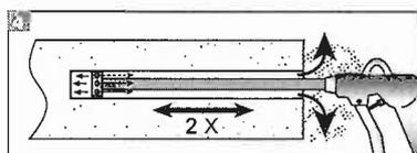
Bohrloch vom Grund her mit passendem Düsenaufsatz
