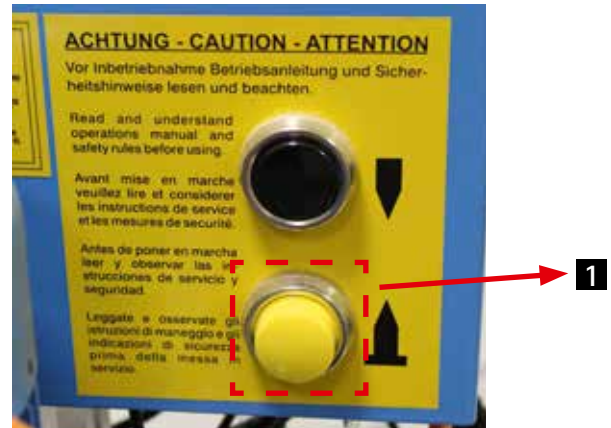
Abb. 27: gelbe Taste: Lösen der Niederhalter
