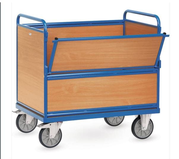
Stahlrohr und Profilstahl geschweißt, pulverbeschichtet blau RAL 5007. Boden aus Holzwerkstoffplatte, Oberfläche Buchendekor. Verschraubte Baukasten-Ausführung: Mit Stahlrohr-Aufbau, Wände aus Holzwerkstoffplatte, Oberfläche Buchendekor. 2 Lenk- und 2 Bockrollen, TPE-Bereifung, Naben mit Rillenkugellager. Feststeller an den Lenkrollen. Zerlegte Anlieferung. Nutzhöhe: 700 mm.
