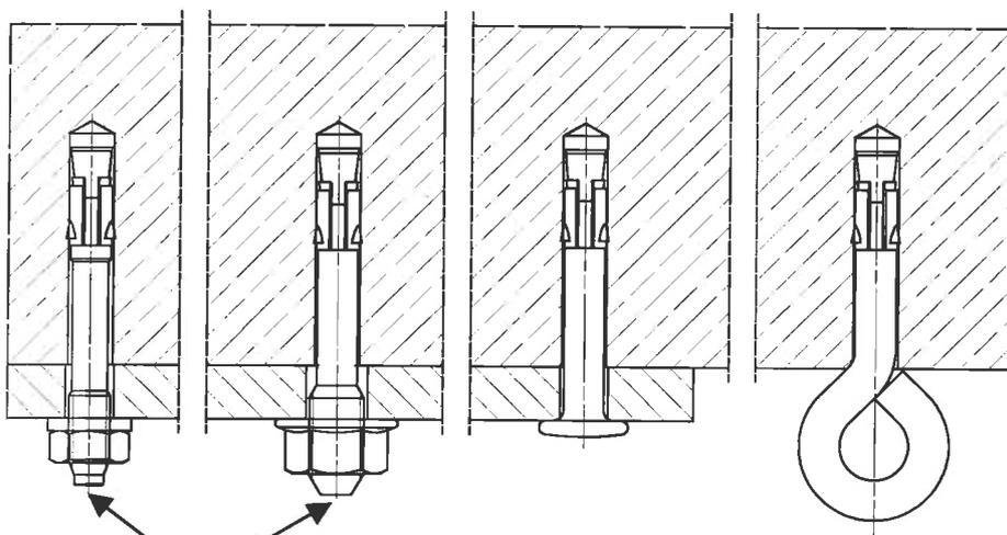
Markierung nur für galvanisch verzinkte Ausführung (gvz) mit einer Verankerungstiefe von  $h_{ef} = 25 \text{ mm}$  (Zentrierung, Balken oder Punkt)
