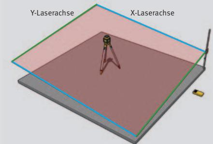
Kontrollierte Neigungseinstellung – die Nivellierebene kann mit der Fernbedienung auf zwei Achsen um bis zu 5° geneigt werden.
