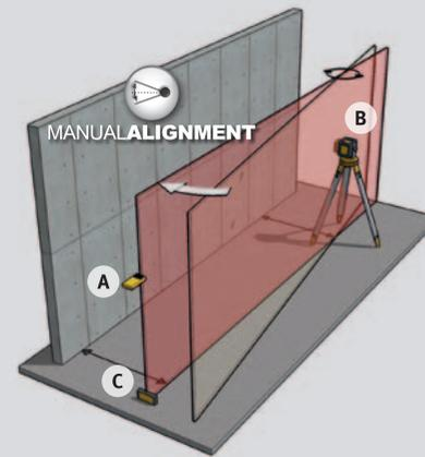
Mit Hilfe der Fernbedienung (A) wird der Laser LAR 350 (B) an den Zielpunkt REC 300 Digital (C) präzise herangefahren.
