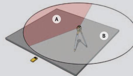
Individuell begrenzbarer Arbeitsbereich im Rotationsbetrieb. Der Laserstrahl wird nur in einem definierten Bereich A ausgestrahlt – keine gegenseitige Beeinflussung beim Einsatz von mehreren Rotationslasern auf der Baustelle, keine Gefahr des unbeabsichtigten Blendens von Dritten.
