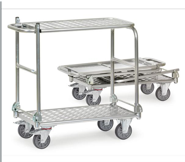
Klapptischwagen aus Alurohr mit Aluplattform. Sehr geringes Eigengewicht. Mit 2 klappbaren Bügeln und mit klappbarer Tischplattform ist der zusammen klappbare Tischwagen auch ideal für unterwegs. 2 Lenk- und 2 Bockrollen mit spurloser TPE-Bereifung und Naben mit Rillenkugellager. Feststeller an den Lenkrollen. Tragkraft obere Ladefläche 80 kg. Deutsches Patent 100 62 425.
