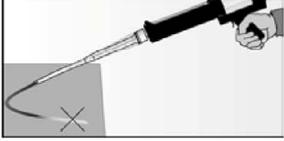
Einen etwa 10 cm langen Strang auspressen, bis der Mörtel gleichmäßig grau gefärbt ist. Nicht gleichmäßig grauer Mörtel ist zu verwerfen. |
