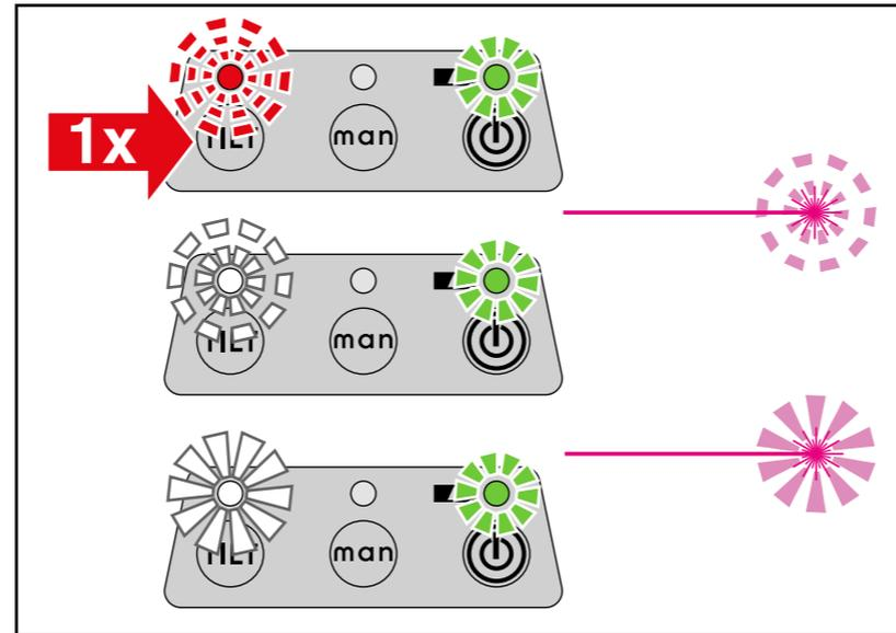
Mit der Tiltfunktion wird nach eingetretenen Störungen gewarnt. Dadurch bleiben Störeinflüsse nicht unbemerkt. Diese Betriebsart ist immer direkt nach dem Einschalten eingestellt. In der Betriebsfunktion „Automatik“ nivelliert sich das Lasergerät automatisch ein.
