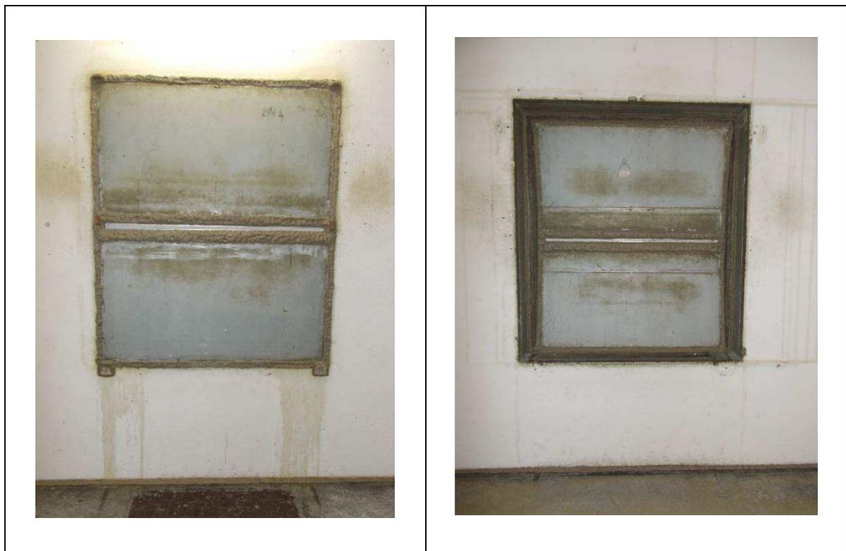
**Bild 3** Foto des eingebauten Elementes (erstellt vom ift Labor Bauakustik)
