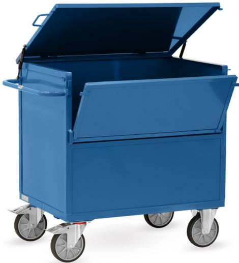
Stahlrohr und Profilstahl geschweißt, pulverbeschichtet blau RAL 5007. Boden aus Stahlblech, pulverbeschichtet. Winkelstahl-Konstruktion. Wände aus gesicktem Stahlblech, eingeschweißt, pulverbeschichtet. 2 Lenk- und 2 Bockrollen, TPE-Bereifung, Naben mit Rillenkugellager. Feststeller an den Lenkrollen. Nutzhöhe: 816 mm.
