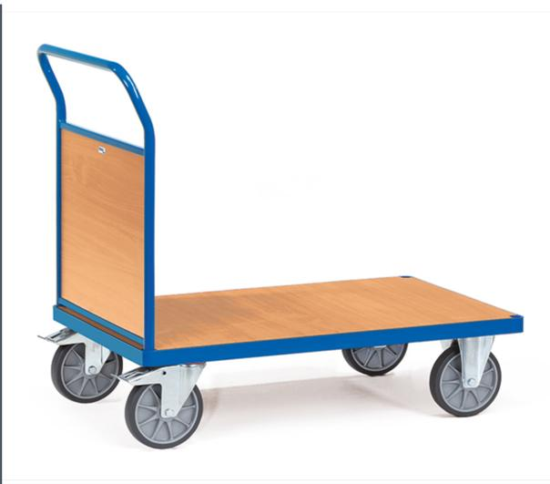
Stahlrohr und Profilstahl geschweißt, pulverbeschichtet RAL 5007, Plattform Holzwerkstoffplatte, Oberfläche Buchendekor. Stirnwand aus Holzwerkstoffplatte, Oberfläche Buchendekor, Wand 500 mm hoch. 2 Lenk- und 2 Bockrollen, TPE-Bereifung, Naben mit Rillenkugellager. Feststeller an den Lenkrollen.
