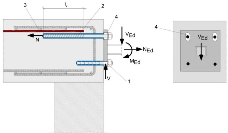
Die erforderliche Querbewehrung nach EN 1992-1-1:2004+AC:2010 ist in den Bildern nicht dargestellt. **Mit dem fischer Bewehrungsanker FRA dürfen nur Zugkräfte in Richtung der Stabachse übertragen werden.** Die Zugkraft muss über einen Übergreifungsstoß mit der im Bauteil vorhandenen Bewehrung weitergeleitet werden. Der Querlastabtrag ist durch geeignete zusätzliche Maßnahmen sicher zu stellen, z.B. durch Schubknaggen oder durch Dübel mit einer europäisch technischen Bewertung (ETA)
