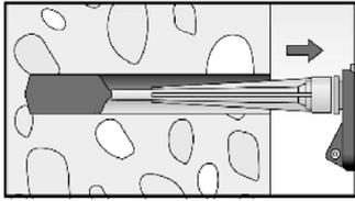
Das Bohrloch vom Grund her mit Mörtel verfüllen. Bei jedem Hub den Mischer langsam zurückziehen. Luftblasen sind zu vermeiden. Das Bohrloch zu ca. 2/3 mit Mörtel verfüllen, um sicher zu gehen, dass der Ringspalt zwischen Betonstahl und Beton über die gesamte Einbindetiefe vollständig verfüllt ist. Die Bedingungen für die Mörtelinjektion ohne Verlängerungsschlauch sind **Tabelle B5.3** zu entnehmen.
