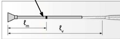
Jeweils eine Markierung für die erforderliche Mörtelmenge  $l_m$  und die Einbindetiefe  $l_v$  bzw.  $l_{e,ges}$  anbringen (Klebeband oder Markierungsstift)
