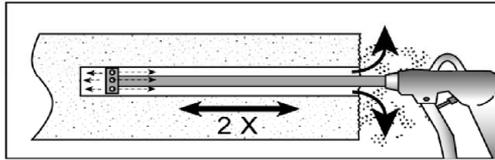
Bohrloch vom Grund her mit passender Druckluftdüse zwei mal ausblasen (ölfreie Druckluft  $\geq 6$  bar) bis die ausströmende Luft staubfrei ist. Persönliche Schutzausrüstung ist dringend zu verwenden (siehe Hinweise **Anhang B 7**).
