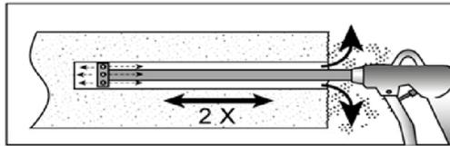
Bohrloch vom Grund her mit passender Druckluftdüse zwei mal ausblasen (ölfreie Druckluft  $\geq 6$  bar) bis die ausströmende Luft staubfrei ist. Persönliche Schutzausrüstung ist dringend zu verwenden (siehe Hinweise **Anhang B 7**).
