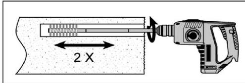
Edelstahlbürste mit Bürstenkontrollschablone prüfen. Passende Edelstahlbürste mit Verlängerung in Bohrmaschine spannen und das Bohrloch zwei mal ausbürsten.
