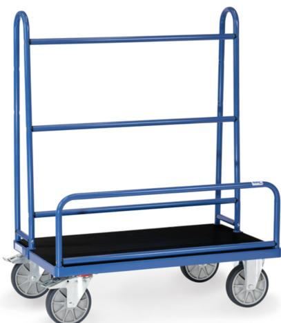
Plattenwagen aus Stahlrohr- und Profilstahl geschweißt, pulverbeschichtet blau RAL 5007. Plattform Holzwerkstoffplatten mit aufgeklebtem Feinriefengummi. Rutschhemmend und schonend für empfindliche Transportgüter. Aufbau Stahlrohr-Konstruktion verschraubt. 2 Lenk- und 2 Bockrollen, TPE-Bereifung, 200 x 40 mm, Nabens mit Rillenkugellager. Feststeller an den Lenkrollen. Anlagehöhe: 1050 mm, Haltebügelhöhe: 300 mm.
