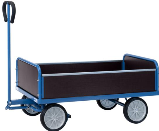
Aus Profilstahl und Stahlrohr geschweißt, pulverbeschichtet blau RAL 5007. Mit Ladefläche, 2 Stirnwänden 300 mm hoch, Stahlrohrrahmen mit wasserfesten Sperrholz und 2 Einstektlängswänden 220 mm hoch aus wasserfesten Sperrholz. Drehschemel-Lenkung mit Deichsel und Handgriff. Räder mit Vollgummibereifung, Naben mit Rollenlager. Deichsel mit Sicherheitshandgriff mit Softgripbezug und automatischer gedämpfter Rückstellung in Ruheposition. Automatische Feststellbremse auf die Vorderräder wirkend.
