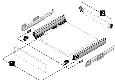
**1 Set Zarge besteht aus:** 1 Stück Zarge, links und rechts, 2 Stück Frontbefestigungen zum Einschlagen, 2 Stück Abdeckkappen, Befestigungsmaterial
