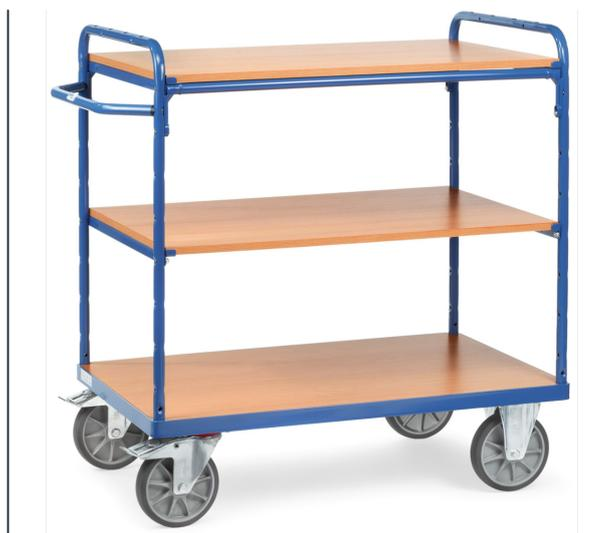
Baukasten-System: Aus Stahlrohr und Profilstahl geschweißt, pulverbeschichtet blau RAL 5007, Schraubkonstruktion. Stirnwände offen. 1 fester und 2 lose Einlegeböden aus Holzwerkstoffplatten, Oberfläche Buchendekor. Einlegeböden variabel einsetzbar, Teilung 100 mm. Tragkraft pro Einlegeboden 90 kg. 2 Lenk- und 2 Bockrollen, TPE-Bereifung, Naben mit Rillenkugellager. Feststeller an den Lenkrollen.
