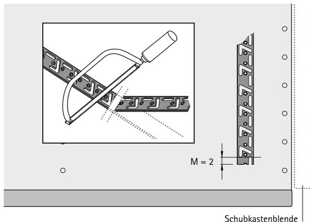
Wird eine Stop Control Verriegelungsstange gekürzt, so ist ein Mindestabstand  $M = 2$  mm einzuhalten
