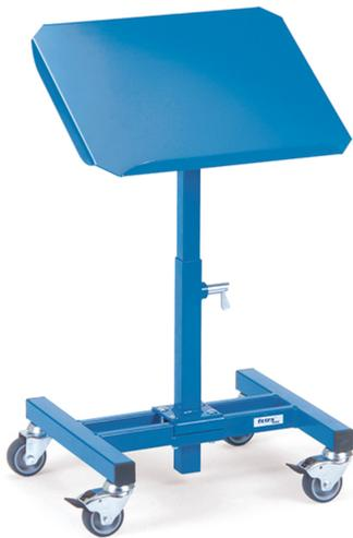
Für Kunststoffkästen, Stahlblechkästen, Drahtkörbe usw., höhenverstellbar und fahrbar. Profilstahl-/Rohrkonstruktion mit Stahlblechplattform mit einseitiger Anlagekante, neigbar um 15° und 30°. Höhenverstellbar im Raster von 25 mm. Pulverbeschichtet brillantblau RAL 5007. 4 Lenkrollen mit TPE-Bereifung, Naben mit Gleitlagerung. Feststeller an 2 Lenkrollen.
