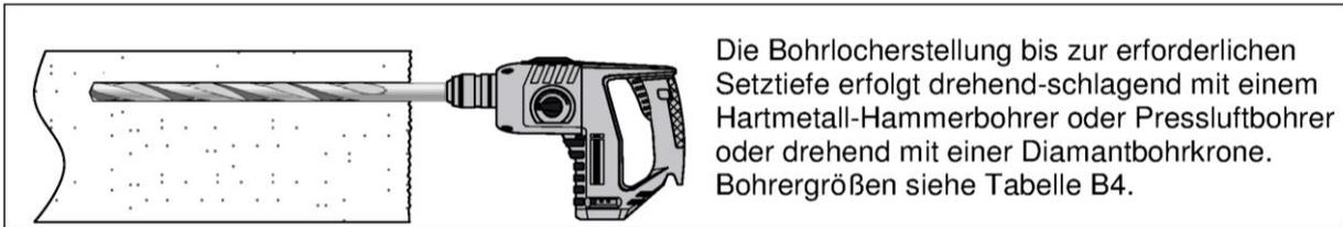
Die Bohrerstellung bis zur erforderlichen Setztiefe erfolgt drehend-schlagend mit einem Hartmetall-Hammerbohrer oder Pressluftbohrer oder drehend mit einer Diamantbohrkrone. Bohrergrößen siehe Tabelle B4.
