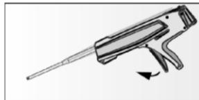
Nach der Bohrlochverfüllung den Hebel der Auspresspistole nach vorn drücken um Mörtelnachlauf zu vermeiden.
