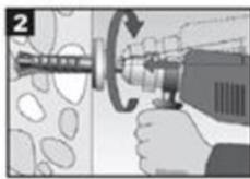
Nach dem Anliegen des Tiefenanschlags des FZUB am Beton wird durch kreisförmige Schwenkbewegungen der Hammerbohrmaschine mit eingeschaltetem Schlagwerk die Bohrlochhinterschneidung hergestellt. Dabei die Hammerbohrmaschine fest gegen den Verankerungsgrund drücken: 1-2 Schwenkbewegungen sind ausreichend für  $\varnothing$  14 mm, 3-5 Bewegungen für  $\varnothing$  18 mm und  $\varnothing$  22 mm.
