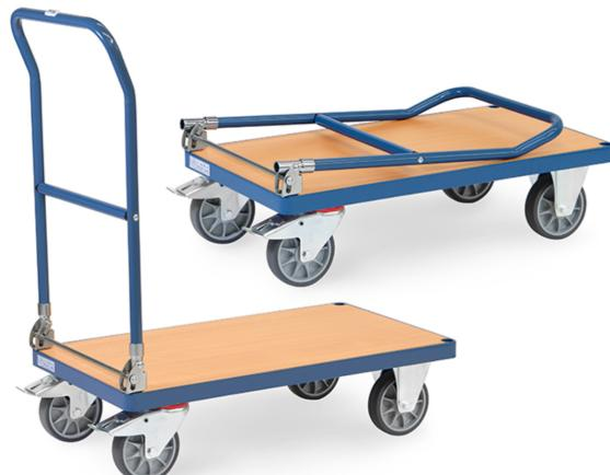
Klappwagen aus Stahlrohr und Profilstahl geschweißt, pulverbeschichtet brilliantblau RAL 5007. Ladefläche aus Holzwerkstoffplatte, Oberfläche Buchendekor. Schiebebügel auf Plattform klappbar. 2 Lenk- und 2 Bockrollen, TPE-Bereifung (spurlos), Nabenhügel mit Rillenkugellager. Feststeller an den Lenkrollen.
