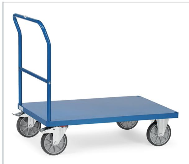
Stahlrohr und Profilstahl geschweißt, pulverbeschichtet RAL 5007, Plattform aus Stahlblech bündig mit Rahmen, sauber eingeschweißt, ebenfalls pulverbeschichtet RAL 5007. 2 Lenk- und 2 Bockrollen, TPE-Bereifung, Nabens mit Rillenkugellager. Feststeller an den Lenkrollen.
