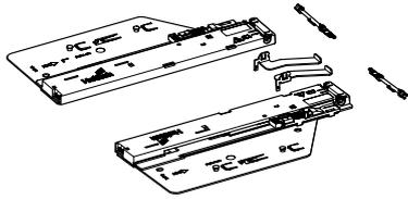
► Für eine optimale Funktion und einen optimalen Auslösebereich wird der Einsatz einer Synchronisation empfohlen
