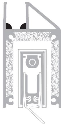
**Befestigungsarten:** Silikonkleber. Zuvor Klebeflächen reinigen nach Kleber-Hersteller-Anleitung.
