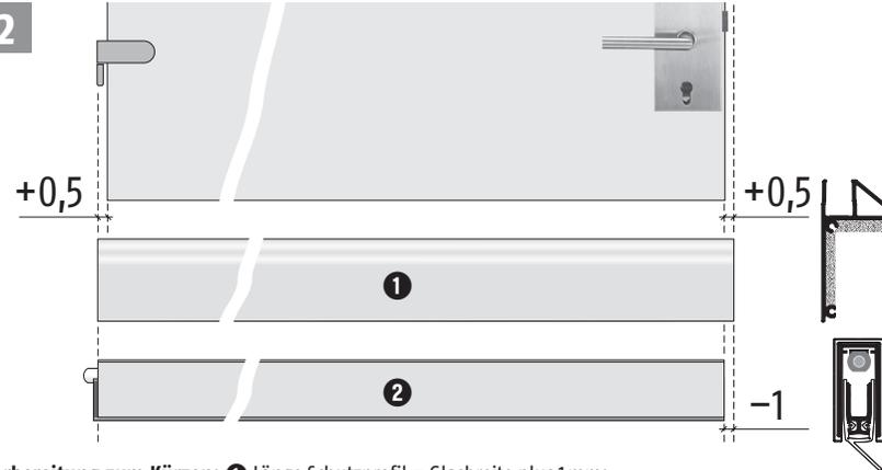
**Vorbereitung zum Kürzen:** ① Länge Schutzprofil = Glasbreite plus 1 mm;
