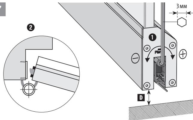
1 Einstellen Hub mit Inbusschlüssel (3 mm), Bodenanzuwendung vermeiden! (siehe Dichtungshöhe D), Funktionskontrolle; 2 Spitze vom Band abgewendet
