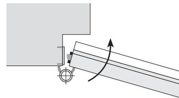
**Bandseitige Auslösung:** Auflaufplatte mittig auf Druckstelle einschlagen (bei Holzzarge)
