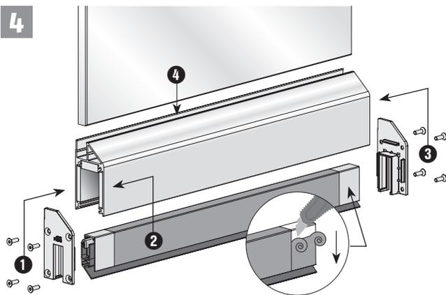
1 Abdeckplatte aufstecken und festschrauben; 2 Dichtung einsetzen und nach vorne schieben; 3 2. Abdeckplatte aufstecken, festschrauben; 4 Klebstoffauftrag: siehe 5.
