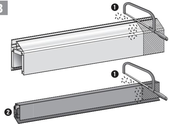
① Schutzprofil / Dichtung kürzen, Späne entfernen;
