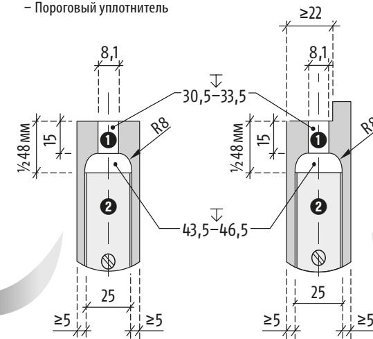
**1 Dichtung:** Ausfrästung 8,1x30,5 mm. Der Planet darf nicht in der Nut klemmen.
