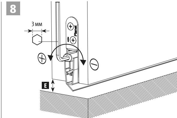
**Einstellen Hub mit Inbusschlüssel (3 mm), Bodenanpressung vermeiden! (siehe Dichtungshöhe E), Funktionskontrolle**
