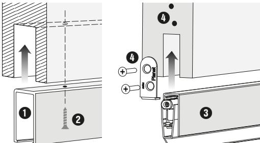
**Montage:** ① MinE-Kanal einsetzen; ② festschrauben (vorbohren), evtl. zusätzlich mit Montagekleber verkleben; ③ Planet einsetzen; ④ beidseitig mit Haltewinkeln befestigen (vorbohren).
