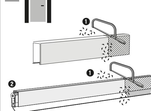
① Überströmkanal / Dichtung kürzen, Späne entfernen;
