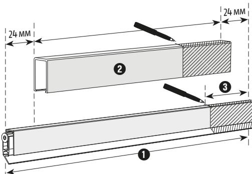
Vorbereitung zum Kürzen: ① Dichtung 1–2 mm kürzer als Türbreite; ② Kanal standardmäßig 48 mm kürzer als Dichtung; ③ Kürzmaß: bis zur nächsten Lagerlänge (max. 125 mm)
