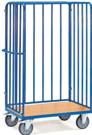
Baukasten-System, Stahlrohr und Profilstahl geschweißt, pulverbeschichtet blau RAL 5007, Schraubkonstruktion. Stirnwände mit vertikalen Rohrstreben im Abstand von ca. 130 mm. 1 Längswand zum Einhängen. Plattform Holzwerkstoffplatte, Oberfläche Buchendekor. Berädern: 2 Lenk- und 2 Bockrollen, TPE-Bereifung, Naben mit Rillenkugellager. Feststeller an den Lenkrollen.
