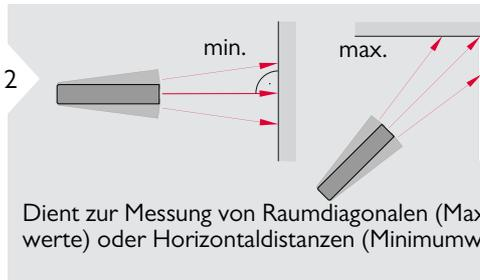
Dient zur Messung von Raumdiagonalen (Maximalwerte) oder Horizontalabständen (Minimumwerte).
