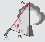
Laser auf die oberen Punkte richten. Das Winkel- / Höhentracking startet automatisch.
