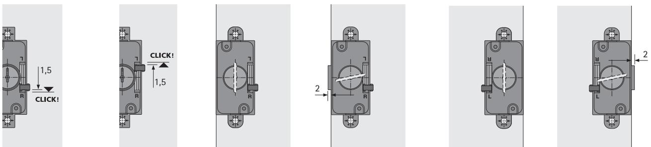
Einstellung Schlüsselabzugssperre Kastendrehstangenschloss
