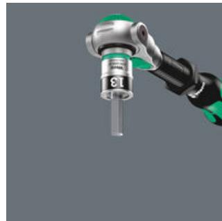
Die Klemmung der Außensechskant-Schraube im Steckschlüsselleinsatz wird durch zwei federnde Kugeln und einen dauerelastischen hochfesten Schrumpfschlauch gewährleistet. Dieser wird durch einen vorderen Stahlbund wirksam gegen mechanische Verletzungen geschützt. Besonders hilfreich in schwer zugänglichen Arbeitsbereichen, wo man die zweite Hand nicht zum Festhalten der Schraube nutzen kann.
