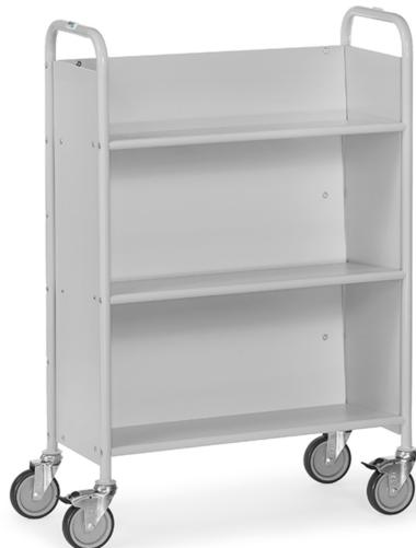
Baukasten-System: Bürowagen mit nach hinten geneigten Böden und Rückwand im rechten Winkel zum Boden. Neigung ca. 27 mm. Verschraubte Stahlrohr-Konstruktion, pulverbeschichtet in lichtgrau RAL 7035. Böden, Seitenwände und Längswand aus Holzwerkstoffplatten, hellgrau. 4 Lenkrollen, Räder mit TPE-Bereifung, elastisch und leicht laufend, spurlos. Nabens mit Gleitlager. 2 Lenkrollen mit Feststeller. Zerlegte Anlieferung, leichte Selbstmontage.
