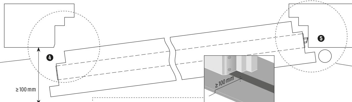
**Verwendungszweck:** Planet-Dichtungen werden in Türen eingebaut und verschliessen die Bodenfuge automatisch. Bitte Anleitung vorgängig lesen.
