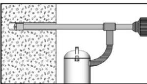
Die Bohrlocherstellung bis zur erforderlichen Setztiefe erfolgt dreh Schlagend mit einem Hammerbohrer (Hohlbohrer).
