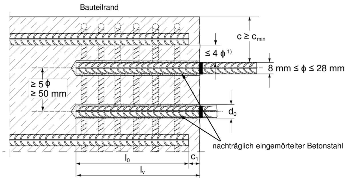
1) Ist der lichte Abstand der gestoßenen Stäbe größer als  $4\phi$ , so muss die Übergreifungslänge um die Differenz zwischen dem vorhandenen lichten Abstand und  $4\phi$  vergrößert werden.
