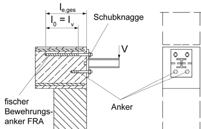
Die erforderliche Querbewehrung nach EN 1992-1-1:2004+AC:2010 ist in den Bildern nicht dargestellt. **Mit dem fischer Bewehrungsanker FRA dürfen nur Zugkräfte in Richtung der Stabachse übertragen werden.** Die Zugkraft muss über einen Übergreifungsstoß mit der im Bauteil vorhandenen Bewehrung weitergeleitet werden. Der Querlastabtrag ist durch geeignete zusätzliche Maßnahmen sicher zu stellen, z.B. durch Schubknaggen oder durch Dübel mit einer europäisch technischen Bewertung (ETA)
