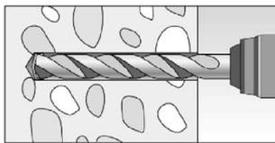
Die Bohrlocherstellung bis zur erforderlichen Setztiefe erfolgt dreh Schlagend mit einem Hartmetall-Hammerbohrer oder Pressluftbohrer.
