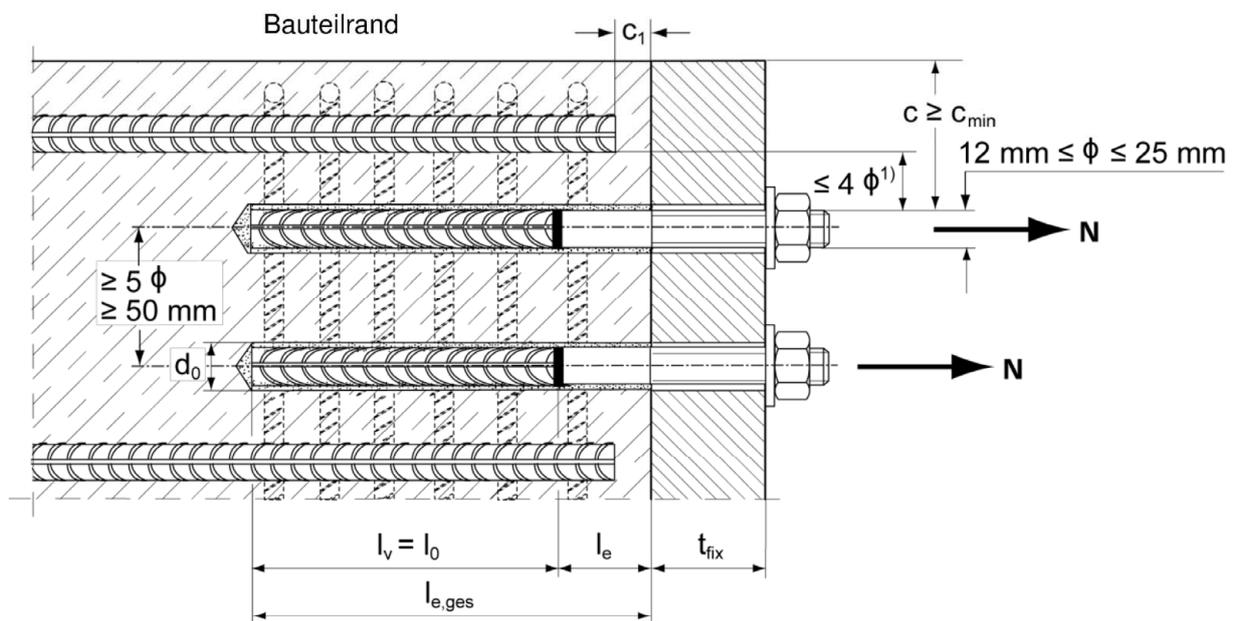
1) Ist der lichte Abstand der gestoßenen Stäbe größer als  $4 \phi$ , so muss die Übergreifungslänge um die Differenz zwischen dem vorhandenen lichten Abstand und  $4 \phi$  vergrößert werden.
