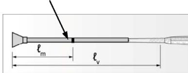
Jeweils eine Markierung für die erforderliche Mörtelmenge  $l_m$  und die Einbindetiefe  $l_v$  bzw.  $l_{e,ges}$  anbringen (Kleband oder Markierungsstift)
