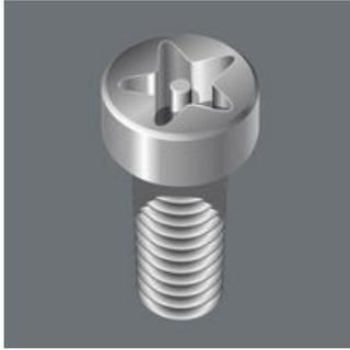
Ein 5-Flanken TORX PLUS® Profil mit Bohrung. Diese Abtriebsgeometrie wurde um eine Flanke verringert und mit Bohrung versehen, um Sicherheitsverschraubungen vor unerwünschtem Lösen zu schützen. Diese Schrauben können nicht mit gängigen, im Handel erhältlichen Werkzeugen betätigt werden.
