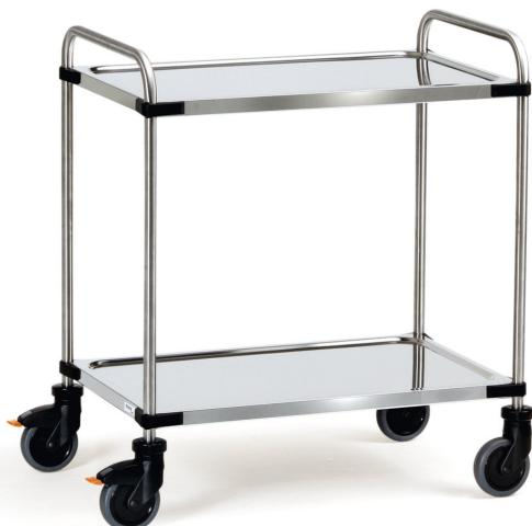
Edelstahlwagen mit Rohrschiebebügeln aus CNS (Chrom-Nickel-Stahl) und 2 tiefgezogenen Böden aus CS (Chrom-Stahl) mit umlaufendem Rand, schalldämmend unterfüttert. Tragkraft pro Etage 80 kg. 4 Lenkrollen mit TPE-Bereifung, elastisch und leicht laufend, spurlos. Nabenhügel mit Kugellager, 2 Lenkrollen mit Feststeller. Rostfreie Rollen gemäß DIN 18867 Teil 8. Zur Vermeidung von starken Beschädigungen mit Kantenschutzecken und Abweiserrollen. Zerlegte Anlieferung, leichte Selbstmontage.
