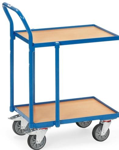
Etagen-Roller mit 2 Plattformen aus Holzwerkstoffplatte im Rahmen liegend, Rand 15 mm hoch. Pulverbeschichtet blau RAL 5007.LICHTER Etagenabstand 500 mm. Tragkraft obere Ladefläche 80 kg. 4 Lenkrollen mit TPE-Bereifung, Naben mit Rillenkugellager. 2 Stück mit Feststeller. Passend für Eurokästen 600 x 400 mm. Zerlegte Anlieferung.
