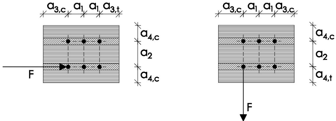
Bei Verschraubungen in den Schmalflächen sind  $a_1$  und  $a_3$  parallel zur Seitenfläche des Brettsperrholzes,  $a_2$  und  $a_4$  rechtwinkelig zur Seitenfläche des Brettsperrholzes angeordnet.
