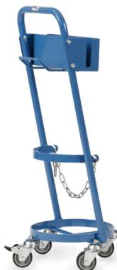
Geschweißte Stahlkonstruktion, pulverbeschichtet blau RAL 5007. Innen-Ø 310 mm. Mit Schlauch- und Schrumpfpistolenhalter. 4 Lenkrollen, 2 Stück mit Feststeller, Vollgummi-Bereifung 75 x 25 mm, Nabenhügel mit Kugellager.
