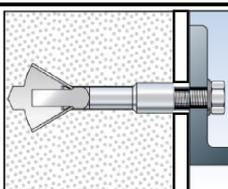
5b: Wenn sich der Dübel beim Anziehen nicht gegen das Anbauteil abstützen kann (Abbildung mit nichttragender Schicht), darf kein Drehmoment aufgebracht werden ( $T_{\max} = 0$ ).
