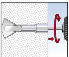
4: Durch das Drehen des Innengewindebolzens wird der Konusbolzen in die Spreizhülse gezogen. Wenn die optimale Verspreizung erreicht ist, wird das Setzwerkzeug aus dem Innensechskant ausgeworfen.
