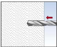
1: Bohrloch erstellen. Andere Methoden zur Bohrlocherstellung wie z.B. Stößeln sind erlaubt. Wenn der Porenbeton mit harten nichttragenden Schichten wie z.B. Fliesen beplankt ist, müssen diese mit dem Außendurchmesser  $\varnothing D$  vorgebohrt werden.
