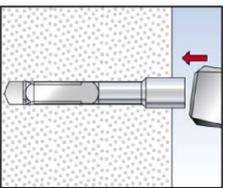
2: Einschlagen des Dübels bündig zur Porenbetonoberfläche.
