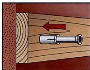
3. Einführen des Dübels (Schraube und Dübelhülse) mit einem Hammer, bis der Rand der Dübelhülse bündig an der Oberfläche des zu befestigenden Teils anliegt.
