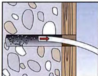
2. Bei Anwendungen in Kategorie „a“ Beton, „b“ Vollbaustoffe, „d“ Porenbeton: Bohrmehl entfernen.
