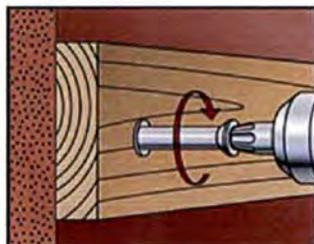
4. Der Dübel ist richtig verankert, wenn nach dem vollen Eindrehen der Schraube weder ein Drehen der Dübelhülse auftritt noch ein leichtes Weiterdrehen der Schraube möglich ist.
