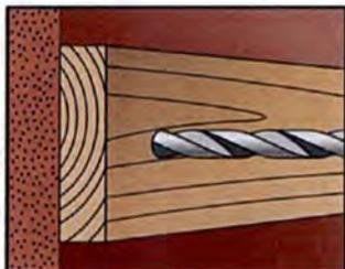
1. Bohrlocherstellung (Durchmesser) gemäß Tabelle B2.1, Bohrverfahren lt. Anhang C.
