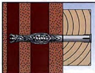
5. Richtig gesetzter Dübel in Hohlmauerwerk.
