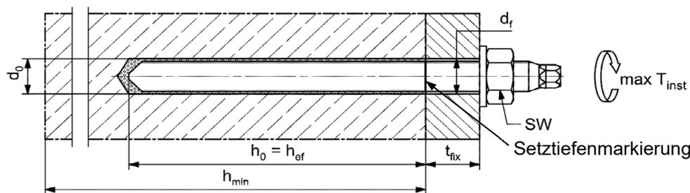
fischer Injektionssystem FIS EM Plus zur Verwendung in unbeschichteten FD-/FDE-Betonflächen in LAU-Anlagen
