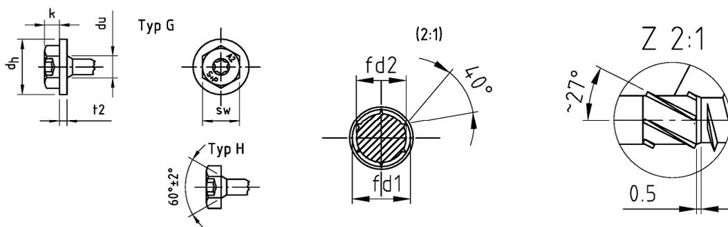
Mit fließendem Übergang vom Gewinde zum Schaft/ with floating crossing between shank and thread
