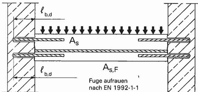
Endverankerung von Platten oder Balken, die gelenkig gelagert berechnet wurden
