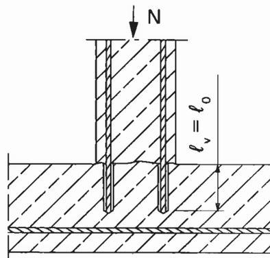
Bewehrungsanschlüsse überwiegend auf Druck beanspruchter Bauteile
