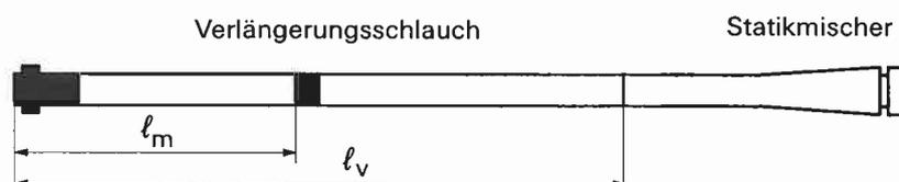
$\ell_v$  geplante Setztiefe = Bohrlochtiefe = minimale Länge des Verlängerungsschlauches.
