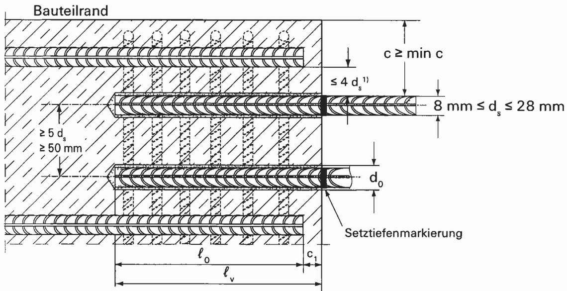
**Bild 10: Einbau Stabanker FRA (Beispiel: Ausführung Glattschaft)**
