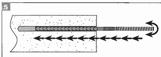
Nach der Aushärtezeit kann der verankerte Stab belastet werden.
