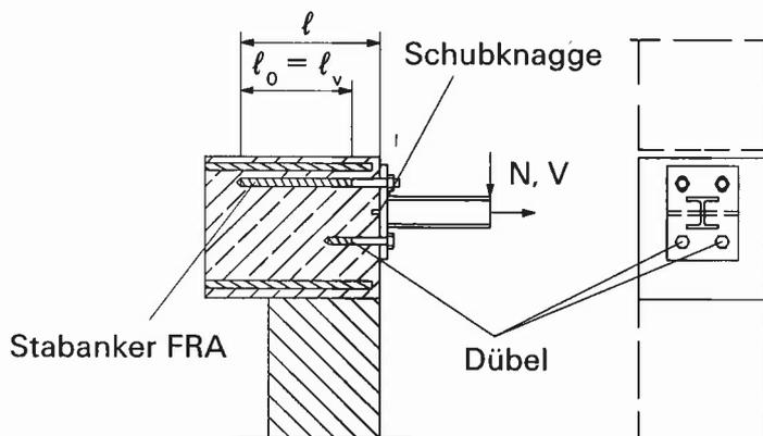
Übergreifungsstoß für die Verankerung von auskragenden Bauteilen
