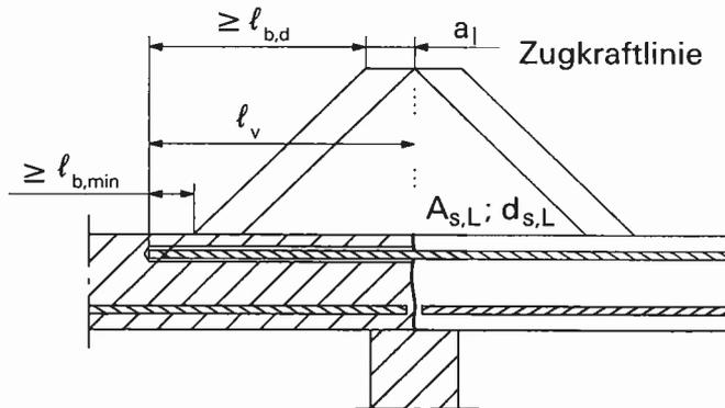
Verankerung von Bewehrung zur Deckung der Zugkraftlinie
