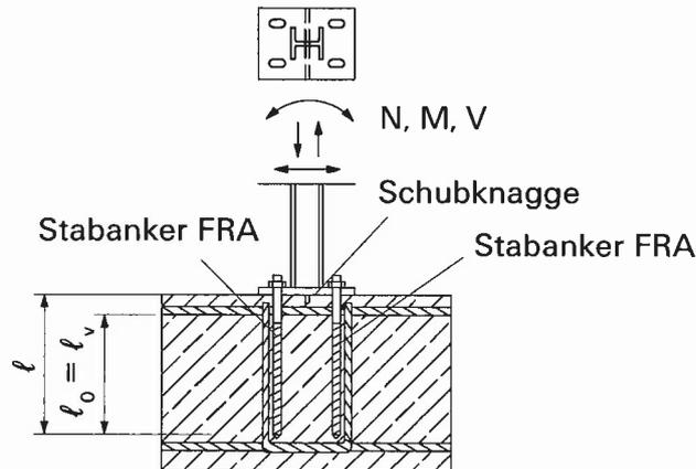
Übergreifungsstoß einer biegebeanspruchten Stütze an ein Fundament
